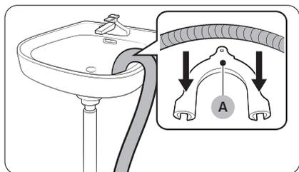
3. Faites passer le tuyau de vidange dans le système d'évacuation.
